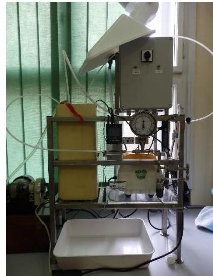
*Slika 2. Shema (lijevo) i slika (desno) membranske aparature u laboratorijskom mjerilu*
