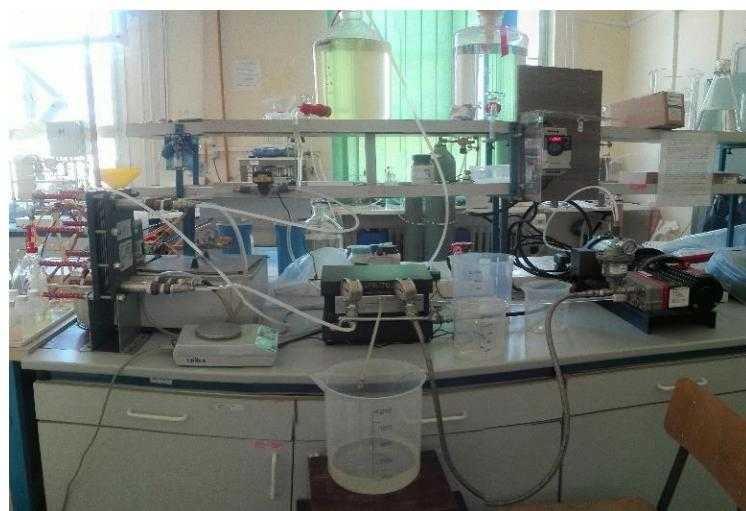
*Slika 3. Shema (gore) i slika (dolje) aparature za membranske procese (UF, NF, RO)*
