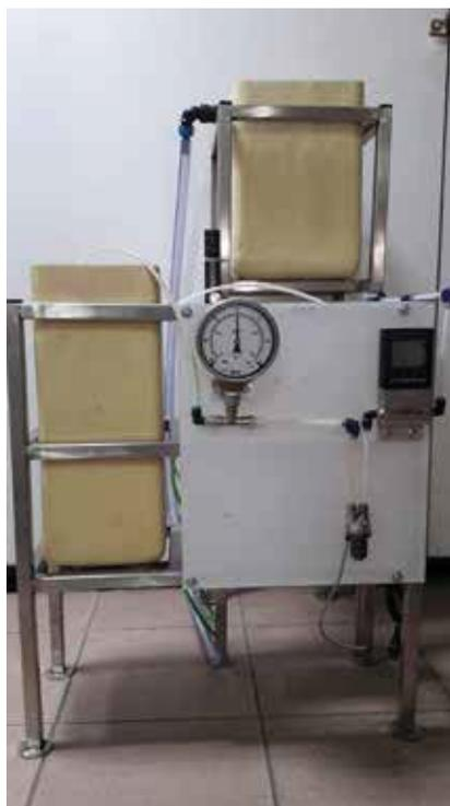
Laboratorijski membranski bioreaktor
