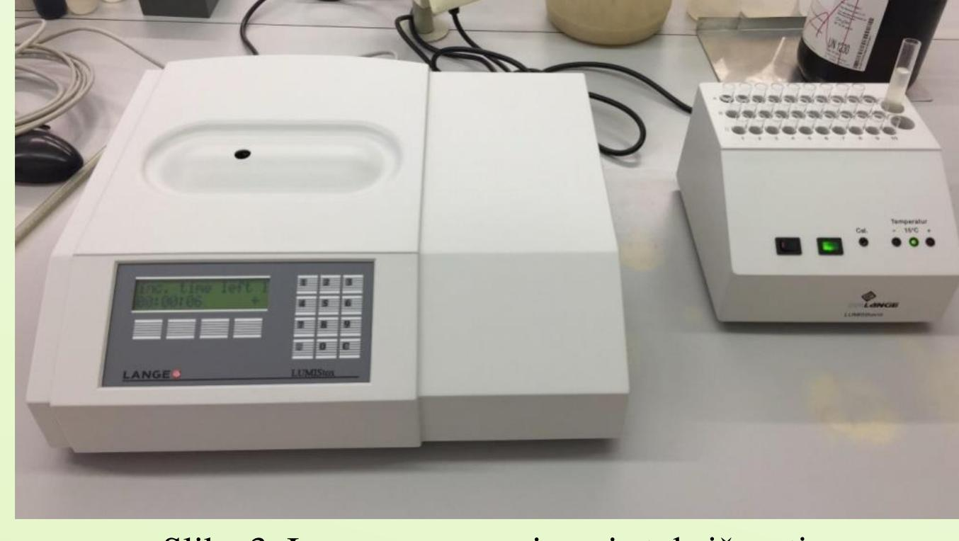
Slika 3. Instrument za mjerjenje toksičnosti
